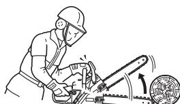
La fonction du frein de chaîne consiste à stopper la rotation de la chaîne en cas de rebond. En aucun cas il n'empêche ni ne diminue le phénomène de rebond.
